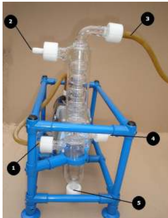
Figura 6: Diagrama de Conexiones Trampa de Vapores.
