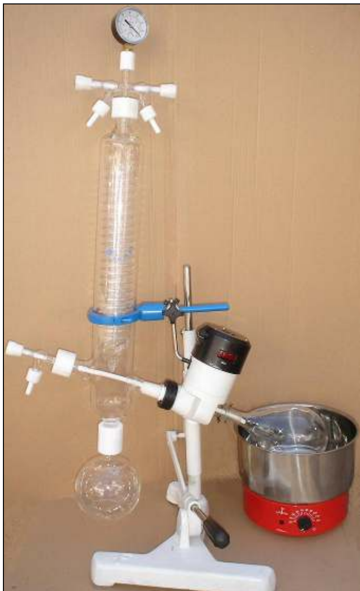
Figura 1: Evaporador Rotatorio Escala Laboratorio
